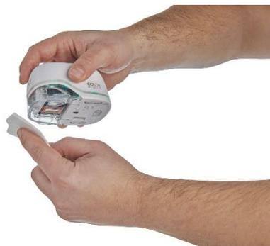
Fig. 19: Pulisci la testina di stampa con un panno umido
