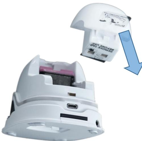
Fig. 6: Pellicola isolante contatti della batteria
