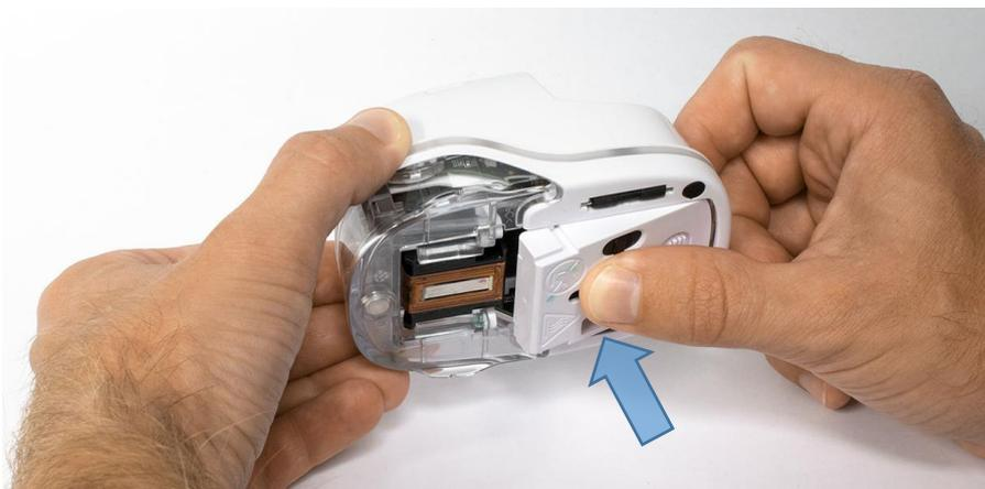
Fig. 32: Chiudere il coperchio ribaltabile inferiore
